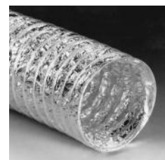
Hochflexibler Aluminiumschlauch 3 Lagen Aluminium 1 Lage Polyester
