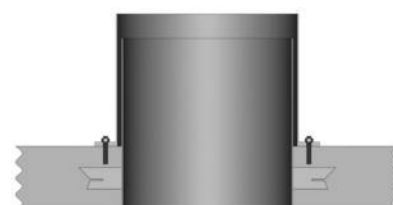
Futterrohr einbetoniert Montage direkt auf Beton
